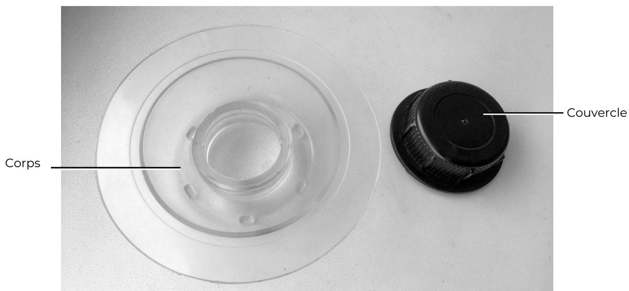
Construction d'une valve sans mamelon
